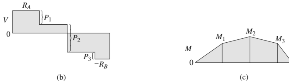
FIGURA 6 Diagramas de fuerza cortante y de momento flexionante para una viga simple con varias cargas concentradas.
